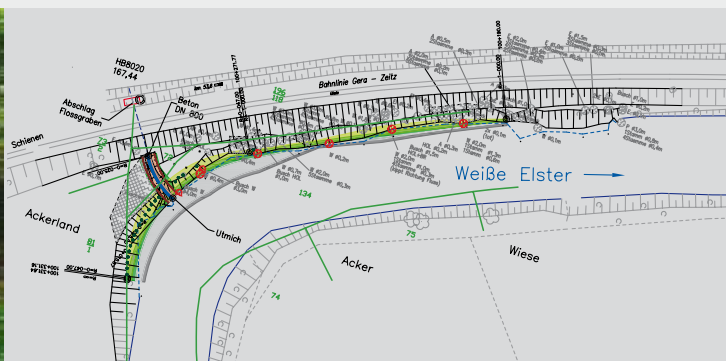
Lageplan Uferböschung, Bereich Auslauf „Am Utmich“
